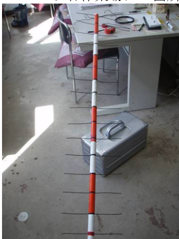
設置した高橋式最大積雪深計
